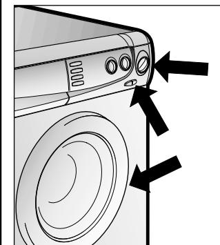
Нажмите на клавишу (C) вкл/выкл, при этом загорится индикатор работы N. Если индикатор не загорится, ищите неисправность.
